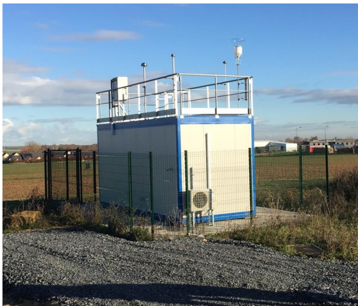
Local abritant les équipements de contrôle d'une station de surveillance de l'environnement
